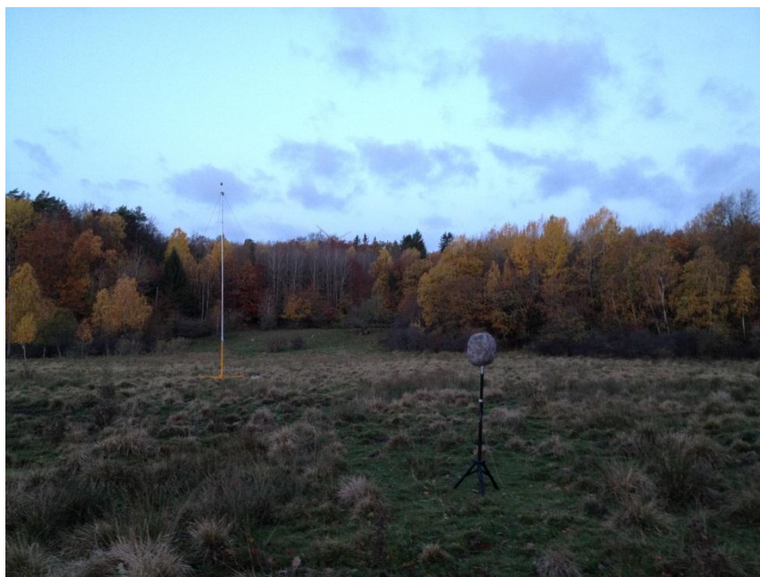
Figur 3. Fotografi mätpunkt A med ljudnivåmätare på stativ och mätmast för meteorologi.
